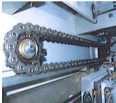
印刷搬送ライン チェーンとスライドレール部
